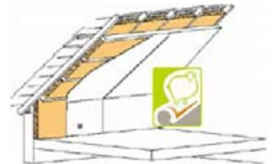
Mise en œuvre Naturlaine sous le rampant
